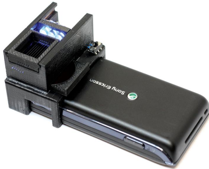
Şekil 1. Cep telefonuna adapte edilebilen Escherichia coli O157:H7 dedektörü ( Analyst , 2012, 137).
